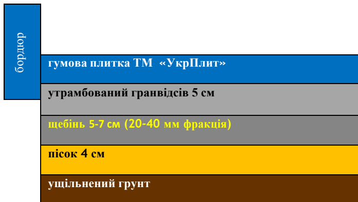
Рис.3 – Підготовка основи для монтажу гумової плитки на ПГС:
