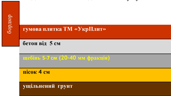
Рис.1 – Підготовка основи для монтажу гумової плитки на бетон:
