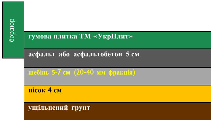
Рис.2 – Підготовка основи для монтажу гумової плитки на асфальт:
